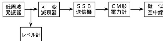
低周波発振器の発振周波数を 1,500 [Hz] とし、その出力をレベル計で監視して常に一定に保ち、可変減衰器を変化させてSSB送信機への変調入力を順次増加させてゆき、SSB送信機から擬似空中線に供給される□A□をCM形電力計の入射電力と□B□の差から求める。この操作をSSB送信機の出力電力が最大になるまで続け、変調入力対出力電力のグラフを作り、□C□を読み取る。このときの□C□の値がSSB送信機出力のA3J電波の□D□となる。
