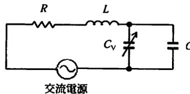
A-5 図に示すRLC並列回路において、抵抗Rの値が25[Ω]、コイルLのリアクタンスが100[Ω]、コンデンサCのリアクタンスが20[Ω]のとき、電流*i*の値として、正しいものを下の番号から選べ。
